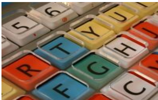
Klawiatura wyposażona w nakładkę zapobiegającą wciśnięciu kliku klawiszy jednocześnie
